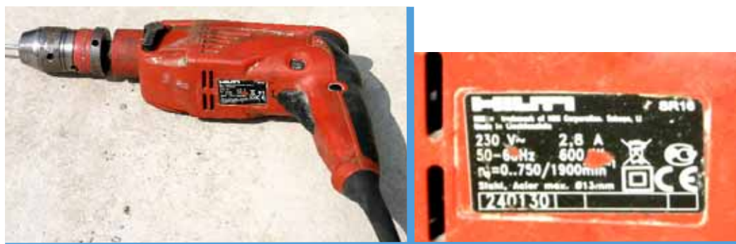
Elektronarzędzie. W powiększeniu tabliczka znamionowa ze znakiem CE. Podwójny kwadrat oznacza, że urządzenie jest w II klasie ochronności, tj. posiada podwójną izolację przed dotykaniem pośrednim i bezpośrednim.
